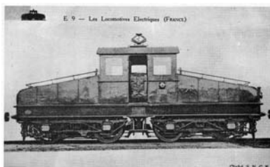
Vue en élévation de la E1 en état d'origine. Le timbre d'alarme et le mini pantographe sont visibles. Document P.O. - collection Bernard ROZE
