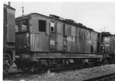
Locomotive E9 série E9 à E11 dans l'état d'origine. Remarquer la forme des extrémités, la partie haute de la cabine étant ainsi effilée. Collection Gachet
