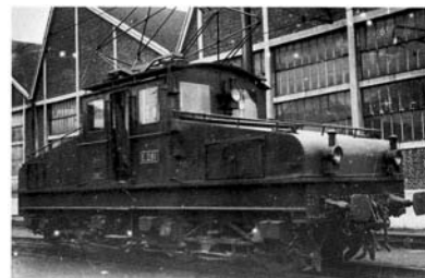
À partir des années 30, les locomotives «boîtes à sel» du P.O. ont été munies d'un groupe convertisseur tournant Métadyne pour être employées aux manœuvres sous caténaire 1500 V, on voit ici la E281 ainsi modifiée au dépôt d'Ivry-sur-Seine. Photo L. HERMANN - collection Maurice MAILLET
