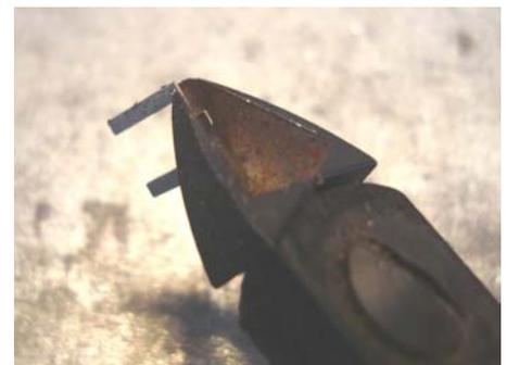
Passer deux fils de laiton à la fois dans les trous de positionnement du guide et de la glissière - diamètre 0.3 ou 0.4 mm selon le diamètre auquel vous les aurez ajustés.
