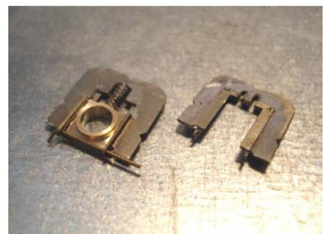
Pour un montage fixe, dégrapper deux cales d'épaisseur et saisir un palier comme indiquer, souder très légèrement pour que la portée du palier reste intacte. Ceci amène le bas du palier exactement à la hauteur de la retenue et assurera l'immobilisation du palier terminé.
