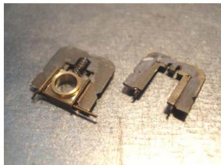
Pour un montage fixe, dégrapper deux cales d'épaisseur et saisir un palier comme indiquer, souder très légèrement pour que la portée du palier reste intacte.
