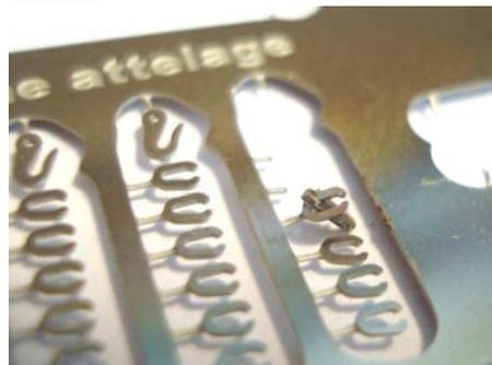
Pour souder, une goutte d'eau à souder sans acide, un paillon de 0.5 mm de soudure de diamètre 0.5 mm, fermer le maillon : hélas, on soude souvent toutes les pièces...
