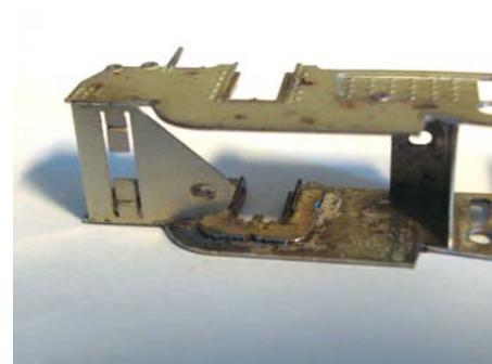
Remplacer la barre de perpendicularité ci-dessus par l'un des faux-essieux du set de montage Isovap.
