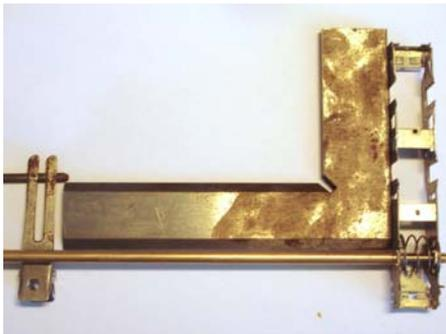
Assurer la perpendicularité de l'essieu par rapport aux longerons à l'aide d'une équerre. Une pince à cheveux est disposée à gauche pour assurer l'horizontalité de la barre. Le ressort inséré sur la barre plaque les glissières contre les longerons.
