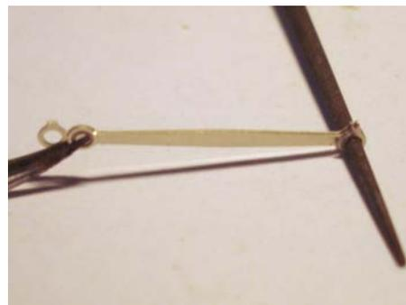
La soudure s'effectue au fer par le champ : avec un bon fluxage, pas besoin d'étamer. Assembler ainsi séparément les tronçons avant et arrière des pièces 301 à 306. Brosser chaque tronçon au polissoir fibre de verre : à l'image de droite, le tronçon avant gauche n'a pas encore reçu ce traitement indispensable. Ebavurer le pourtour pour unifier l'assemblage, rasurer les attachements des surépaisseurs aux articulations 305 et 306.
