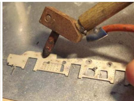
Préparer les entretoises 105 à 108 en ébavurant soigneusement les attaches à la gravure : il est essentiel pour la géométrie des longerons que la largeur soit respectée.
