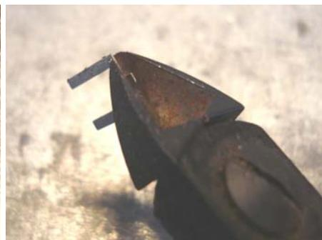
Passer deux fils de laiton à la fois dans les trous de positionnement du guide et de la glissière - diamètre 0.3 ou 0.4 mm selon le diamètre auquel vous les aurez ajustés. Rapprocher les deux pièces au contact.
